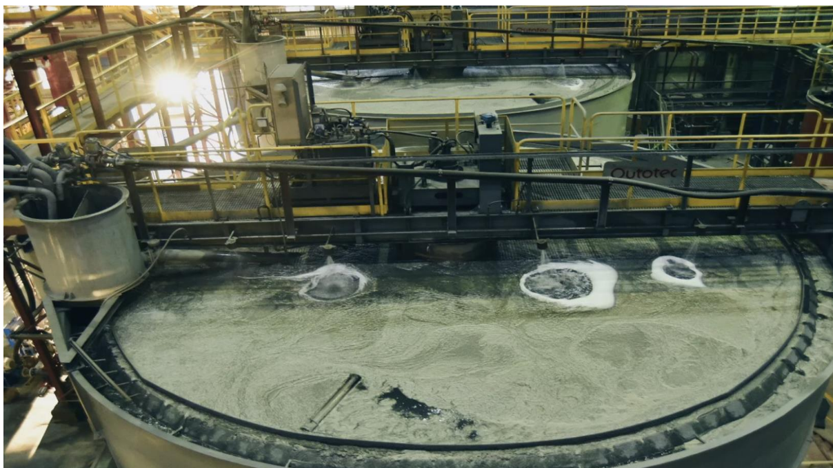
Рисунок 5 – Наглядный процесс флотации руды
