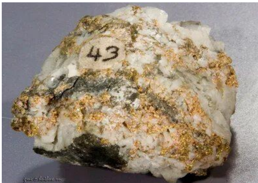
Рисунок 2 – Пирит-содержащий и барит-содержащий свинцово-цинковый состав – полиметаллический и барит-полиметаллический
